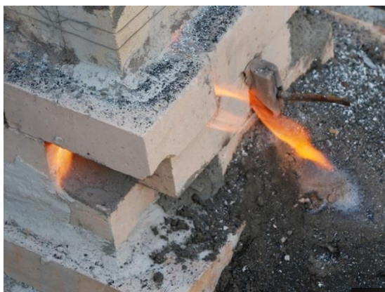
図 6 レンガ接続部より炎が噴出
